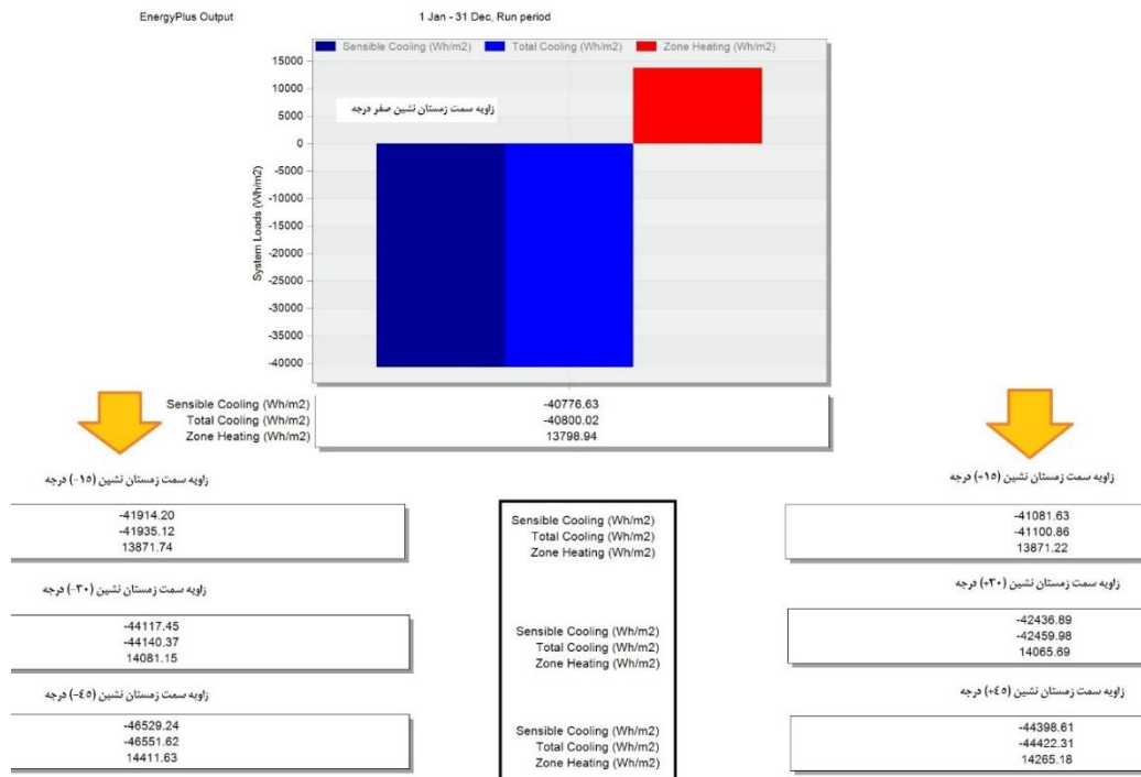
شکل ۶. پیش بینی بار سرمایشی- گرمایشی ساختمان در یک سال در زوایای مختلف
